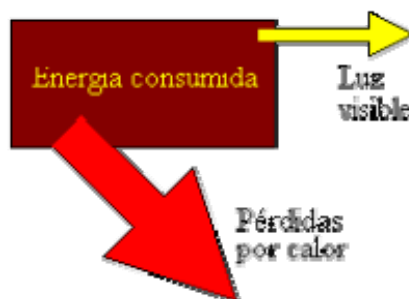
Rendimiento de una lámpara incandescente 3 .
