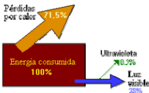
Balance energético de una lámpara fluorescente 3 .
