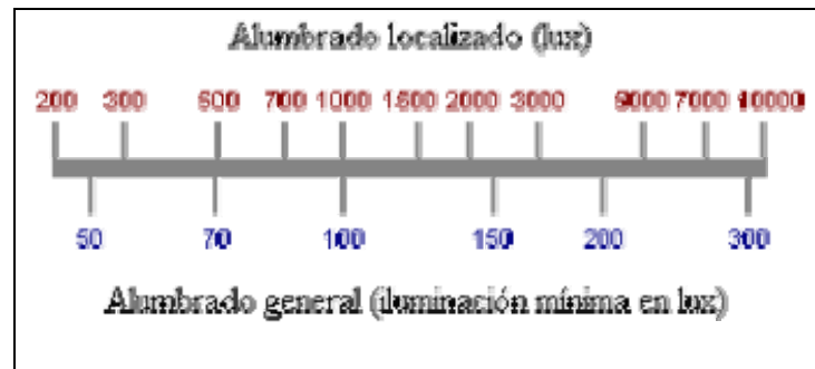
Relación entre el alumbrado general y el localizado 3
