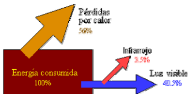
Balance energético de las lámparas de vapor de sodio de alta presión 3 .
