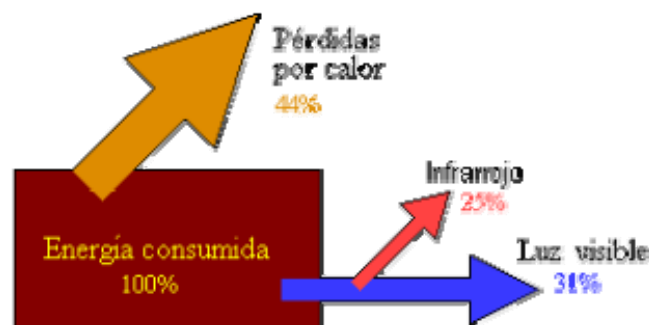
Balance energético de las lámparas de sodio de baja presión 3 .
