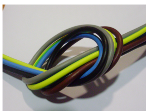
Figura 4.46: Colores para los conductores de las fases, neutro y protección.
