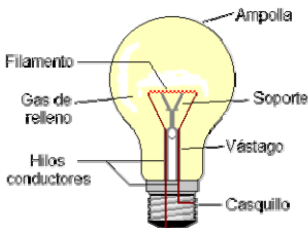
Partes de una bombilla incandescente 3 .
